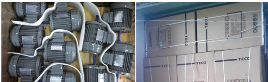
圖：內銷馬達使用巧固籠只做重點防護減少過度包裝
