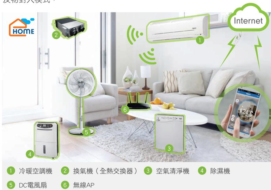
以空調為空氣管理平台的主機，和各設備間傳遞溫度、溼度、污濁度、異味等資訊，達到主動式空氣管理。各家電之間採用P2P技術通訊（low cost），物聯資訊交換順暢。共用雲端伺服器及穿防火牆資源，以APP建立各家電之間的智慧控制情境，掌握Content。
