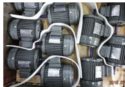
內銷馬達使用巧固籠只做重點防護減少過度包裝
