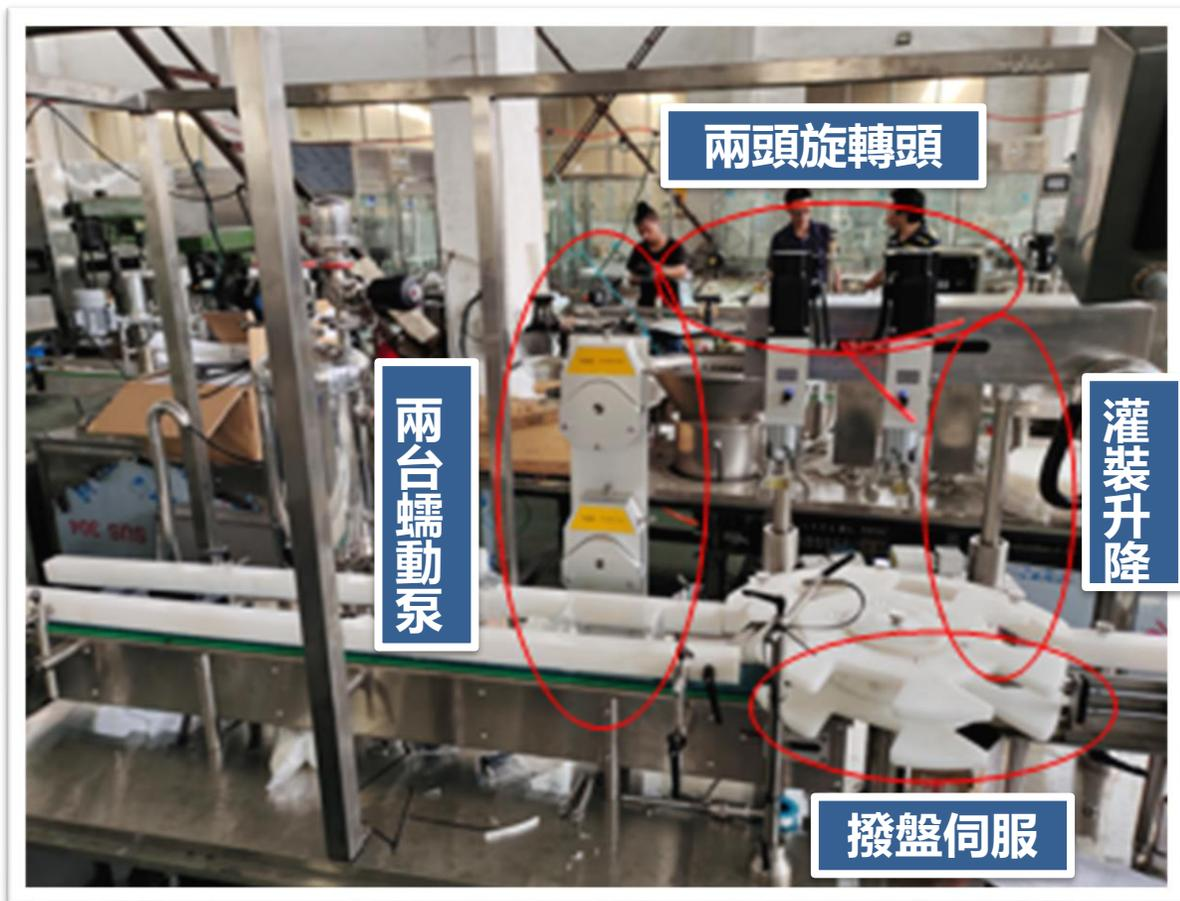
**回原點：**灌裝升降和撥盤電機使用17位多圈絕對值電機，點擊回零後，撥盤電機和升降電機會自動運行至設定位，無需找外部機械點。
