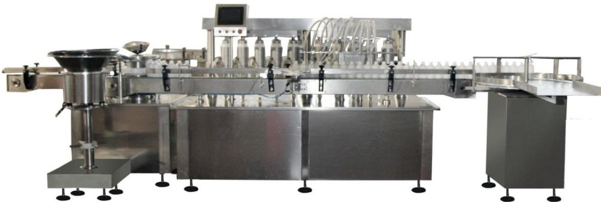
**血清灌裝機**是將血清按照預定量灌注到容器內的一種設備。此案例為2頭血清灌裝機，要求灌裝物料快速、**定量精確、系統穩定、瓶口無劃痕、無粉末**、整機內部環境符合人藥生產環境要求。**整套系統採用東元產品。**
