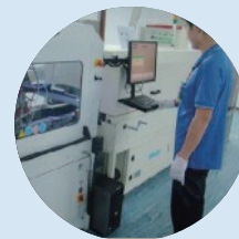
自動Coating產線 提高產品表面耐磨性
