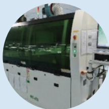
擁有波峰焊爐等先進設備 無鉛製程
